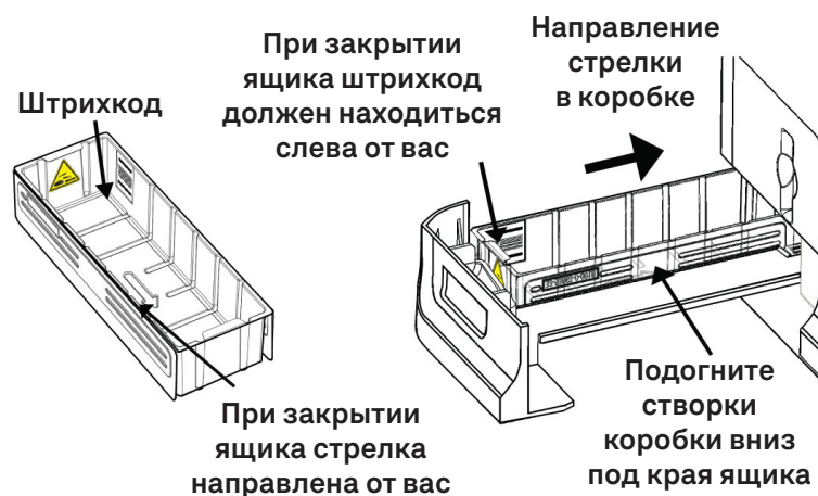
Рисунок 58. Правильное положение коробки для кассет в ящике. Обратите внимание на направление стрелки в коробке.
