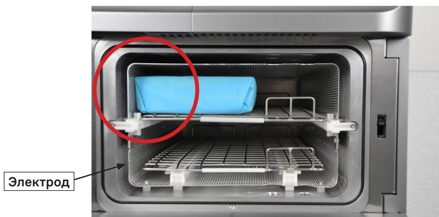
Рисунок 14. Стерилизуемые объекты НЕ должны касаться электрода.
